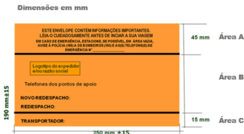
Figura 2 – Formato, disposição das áreas A, B e C e dimensões do envelope para o transporte – frente (ABNT NBR 7503:2018) As áreas A e C citam as dimensões mínimas.
